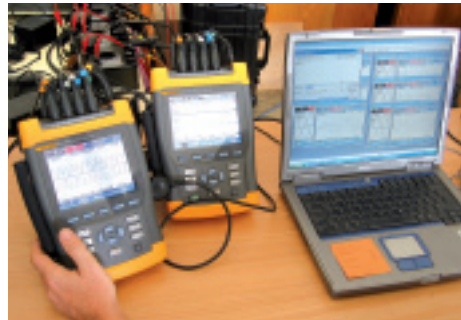
Messgeräte für die Generatornetzanalyse.
